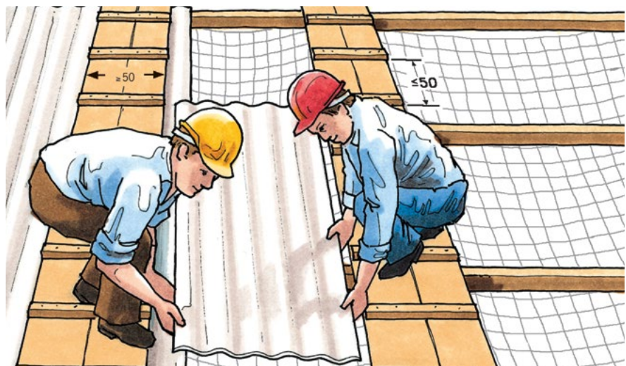
Dachdeckung mit Wellplatten
